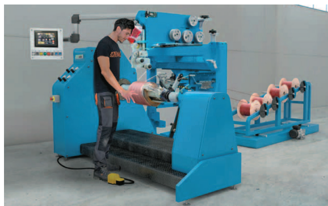
Máquina bobinadora para alambre circular y rectangular.
