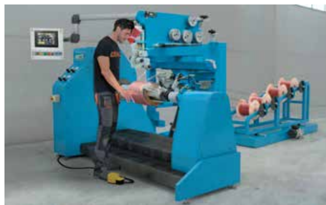
Máquina bobinadora para alambre circular y rectangular.
