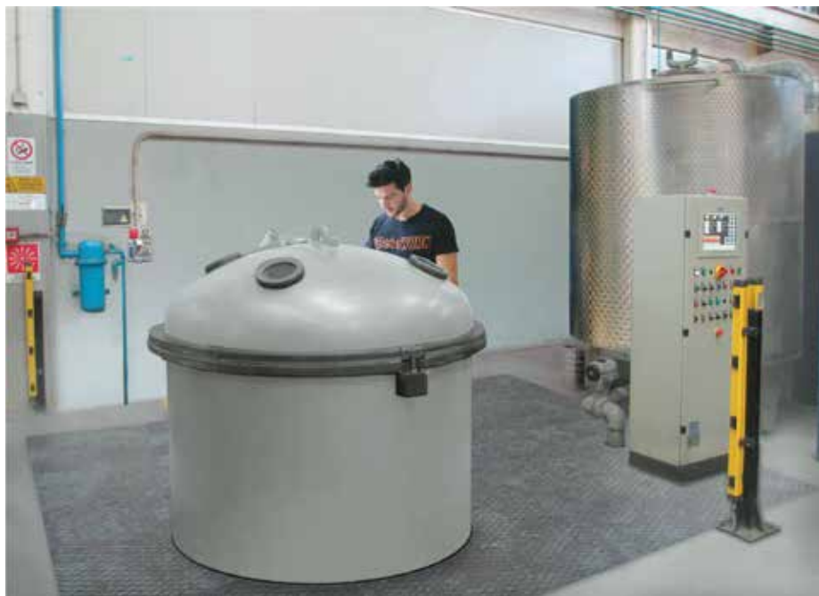
Planta de Impregnación bajo presurización y vacío completamente automatizada y sencilla de utilizar.
